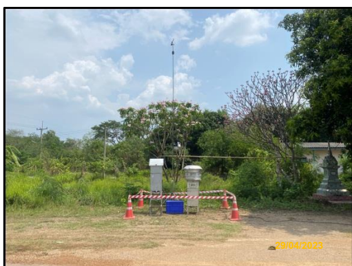
ภาพที่ 3.4 การตรวจวัดคุณภาพอากาศ บริเวณบ้านวังขวาง (บ้านที่อยู่ใกล้ หน้าเหมืองหรือจุดระเบิดมากที่สุด)
